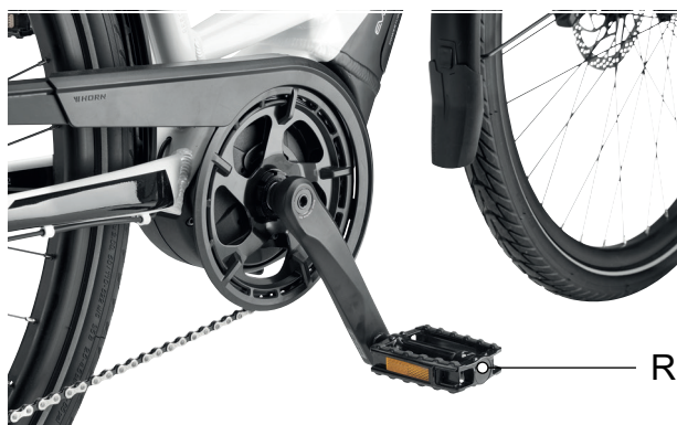
Abbildung 14: R Pedal im rechten Kurbelarm
