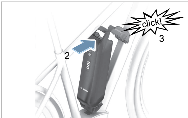
Abbildung 32: PowerPack Akku nach oben klappen
