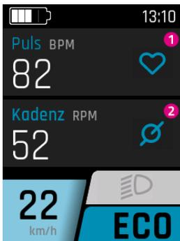
1. Aktueller Puls (Wird nur angezeigt, wenn ein Pulsmesser verbunden ist. Diese Option ist modellabhängig. Es werden nur Pulsgurte ab Bluetooth 4 oder mit Bluetooth Low Energy unterstützt.)
