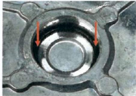
9. Anschließend wird die neue Dichtung auf den Gehäusedeckel aufgelegt. Dann den Deckel mit der neuen Dichtung auf den Motor aufsetzen, ohne zu viel Kraft aufzuwenden. Der Deckel muss nahezu bündig abschließen.
