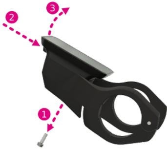
1. Falls die Diebstahlsicherungsschraube montiert ist, Diebstahlsicherungsschraube entfernen.
