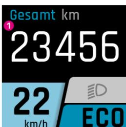
1. Kilometerzähler (Gesamtzahl der Kilometer, welche mit dem E-Bike zurück gelegt wurden. Dieser Wert kann nicht zurückgesetzt werden.)
