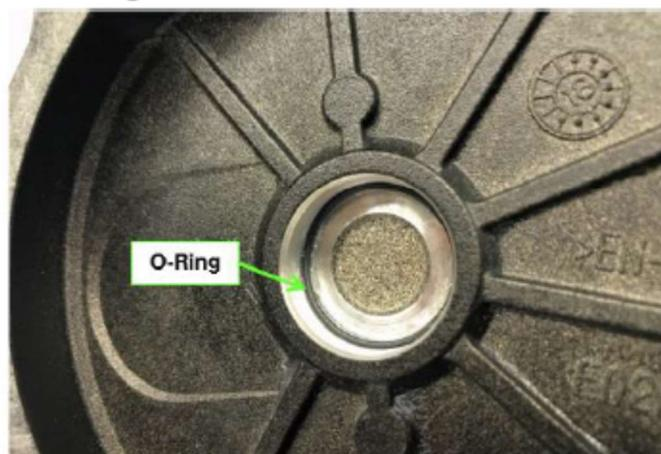
9. Anschließend wird die neue Dichtung auf den Gehäusedeckel aufgelegt. Dann den Deckel mit der neuen Dichtung auf den Motor aufsetzen, ohne zu viel Kraft aufzuwenden. Der Deckel muss nahezu bündig abschließen.
