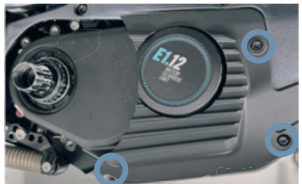
Abbildung 51: Kurbel-Klemmschraube lösen, links
