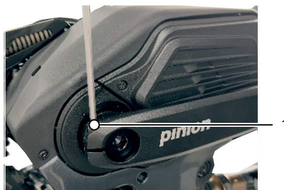
Abbildung 38: Kurbel-Klemmschraube lösen, links
