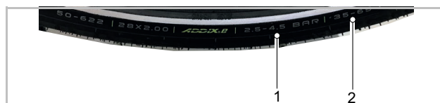
Abbildung 49: Angabe Fülldruck in bar (1) und psi (2)
