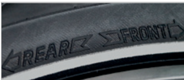
Abbildung 3: Laufrichtungspfeil auf MTB-Reifen
