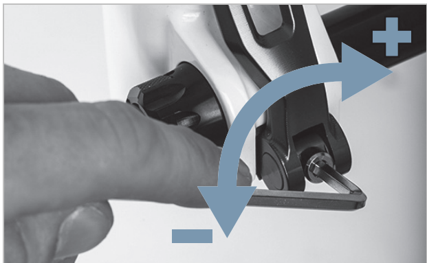
Abbildung 35: Spannkraft des Schnellspanners einstellen
