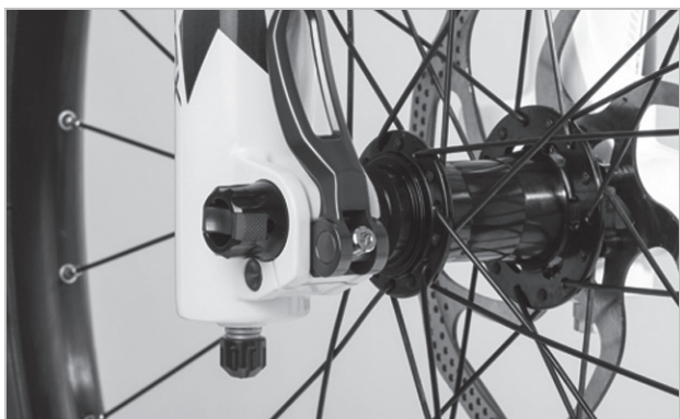
Abbildung 34: Spannkraft des Schnellspanners einstellen
